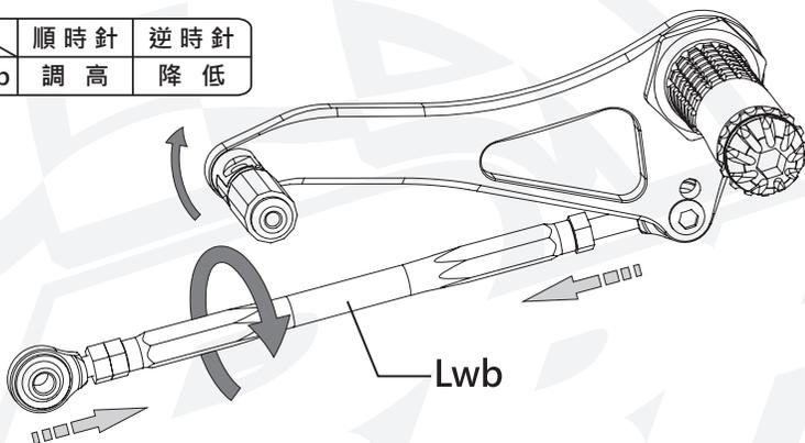
煞車踏桿亦可調整高低角度。
