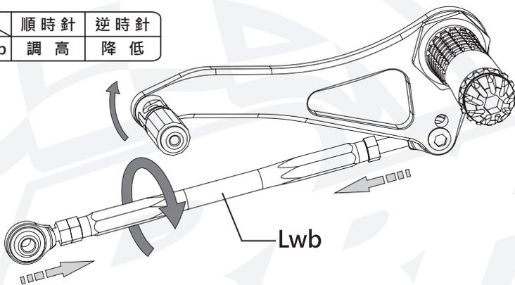
煞車踏桿亦可調整高低角度。
