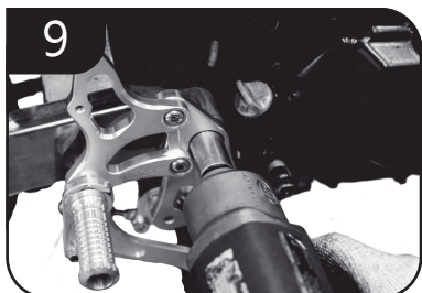
待左右腳踏本體都架上架後，再將搖臂芯螺絲上緊
