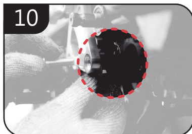
上緊螺絲後請注意是否如上圖中露出間隙，如有間隙請墊入附件 E 華斯，直到與搖臂芯持平
