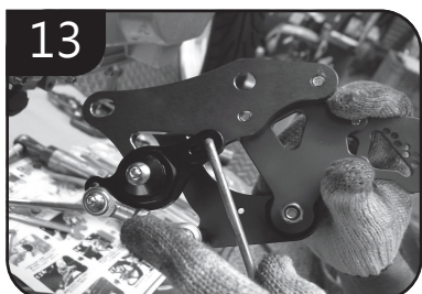
安裝右邊腳踏本體時，需先裝上煞車動件後再安裝腳踏本體，安裝後測試煞車踏桿是否順暢
