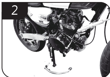
再將煞車踏板拆除
