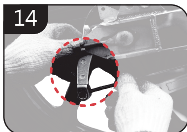
將原廠後煞車搖臂更換成附件 C 後煞車搖臂並且調整煞車
