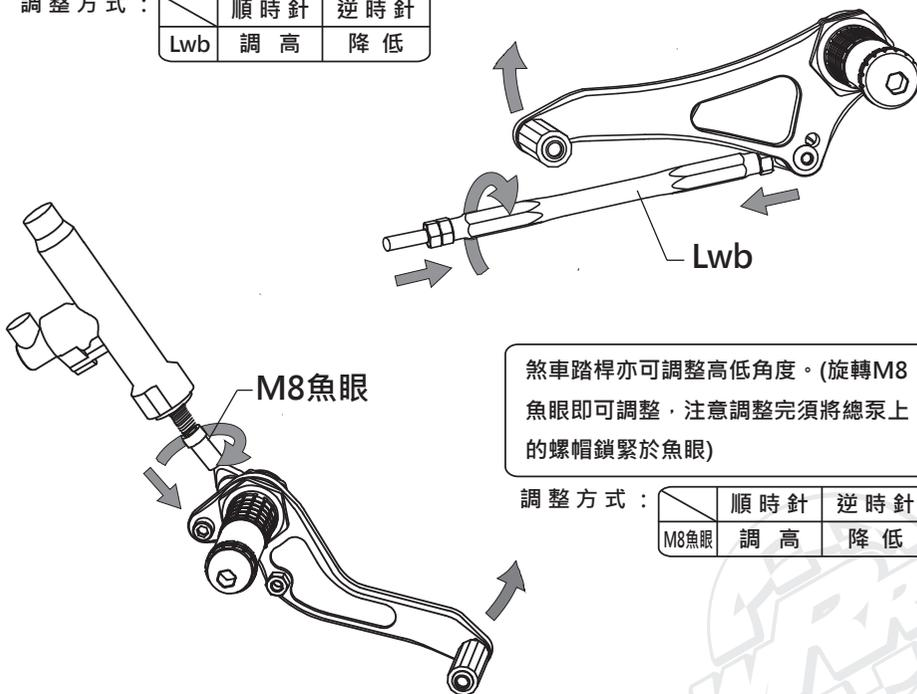
煞車踏桿亦可調整高低角度。(旋轉M8魚眼即可調整，注意調整完須將總泵上的螺帽鎖緊於魚眼)
